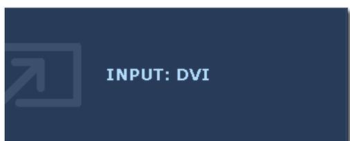
PIP 機能が有効になっているときに Input/Swap (入力 / 切り替え) キーを押し続けると、メインウィンドウの入力ソースを選択したり、メインウィンドウと PIP ウィンドウの入力信号を切り替えたりすることができます。入力ソースを指定するには、選択した入力ソースのメッセージが表示されたら(約3秒間表示されます)キーを放してください。設定は直ちに反映されます。
