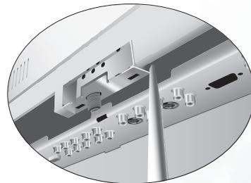
6. 將顯示器後方的蓋板裝回，並使用十字螺絲起子鎖回蓋板固定螺絲。
