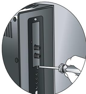
7. 在數位電視盒上有兩個接頭：一個接頭為連接地面數位電視天線輸入之用，另一個接頭為透過回路繞送 (loop-through) 的方式將數位電視訊號輸出至其它裝置之用。
