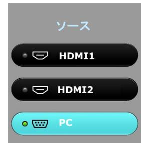
検出されると、選択した入力源の映像が表示されます。プロジェクターに複数の装置が接続されている場合は、ステップ 1-2 を繰り返すと別の信号を検出することができます。
