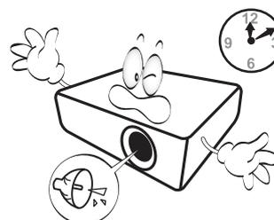
9. Запрещается выполнять замену лампы и других электронных компонентов, пока вилка кабеля питания проектора не извлечена из розетки.
