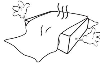
Нарушение вентиляции проектора через отверстия может привести к его перегреву и возникновению пожара.
