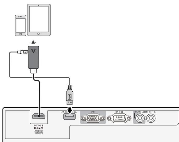
Подключите адаптер к портам **HDMI** и **USB** разъем типа **A** на проекторе, переключите входной сигнал на **HDMI 1**.
