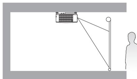
После включения проектора перейти в **Базовый Меню — Настр. > Установка проектора**, нажать **ОК** и **◀/▶** для выбора настройки.
