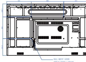
4. 在顯示器背面找到壁掛安裝螺絲孔（如圖所示）。
