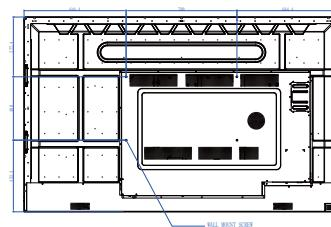
5. 依照壁掛架的安裝說明，將壁掛架安裝於顯示器，以將顯示器安裝於壁面。螺絲長度應至少超過壁掛架厚度 25 公釐。請確認所有螺絲皆已鎖緊固定。(建議扭力：470 - 635N•cm)。壁掛工具的強度應足以負荷顯示器重量。
