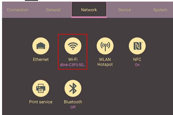
2. 插入 Wi-Fi 硬體鎖，切換工具會自動變更為**開啟**。螢幕上將顯示可用網路的清單。
