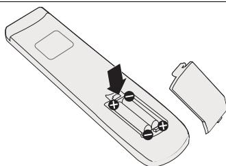
2. 放入隨附的電池，並確認電池的正負極方向符合電池槽中的 (+) 與 (-) 標示。
