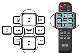
Tekan **▼/▲** pada proyektor atau **▼/▲/▶/◀** pada remote control untuk menampilkan halaman **Keystone 2D**. Tekan **▲/▼** untuk menyesuaikan nilai vertikal dari -20 hingga 20. Tekan **◀/▶** untuk menyesuaikan nilai horizontal dari -20 hingga 20.
